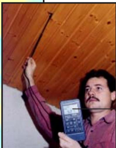
**D**ie Messung des Luftwechsels im Raum und der Strömungsgeschwindigkeit der eintretenden Luft ermöglichen eine Quantifizierung der Undichtheiten.
