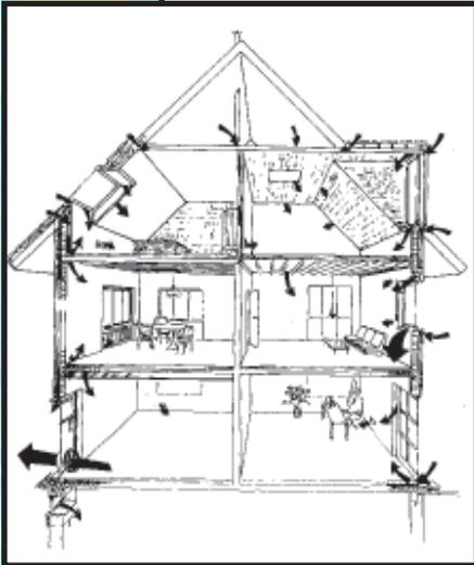
**F**ugenundichtheiten führen bei Gebäuden zu erhöhten Energieverlusten. Dabei auftretende Zugluft verringert darüber hinaus die Behaglichkeit in den Wohnräumen. Dies kann im Extremfall so weit führen, dass einzelne Räume nicht ausreichend beheizt werden können.
